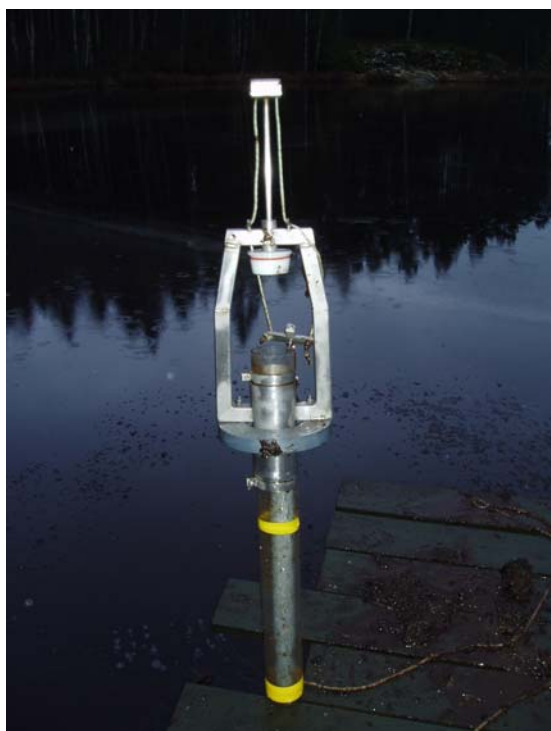
Figur 3-2. Rörhämtare för provtagning av sediment.
